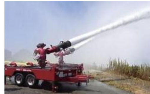
【屋外放水設備】
