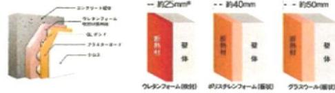
ウレタンフォーム(吹き付け) 25mmは、ポリスチレンフォーム(板状) 40mm、グラスウール(板状) 50mmに相当する断熱性能を持っています
